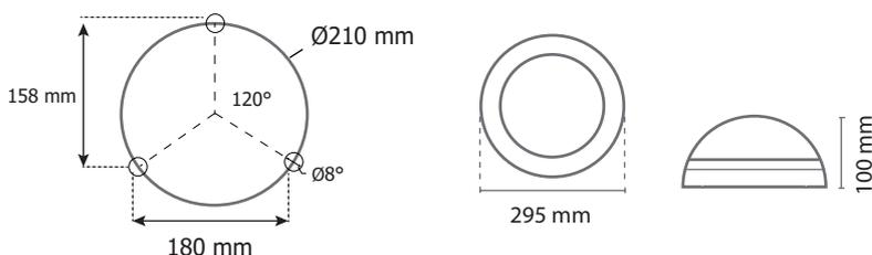
Schéma de pré-perçage
